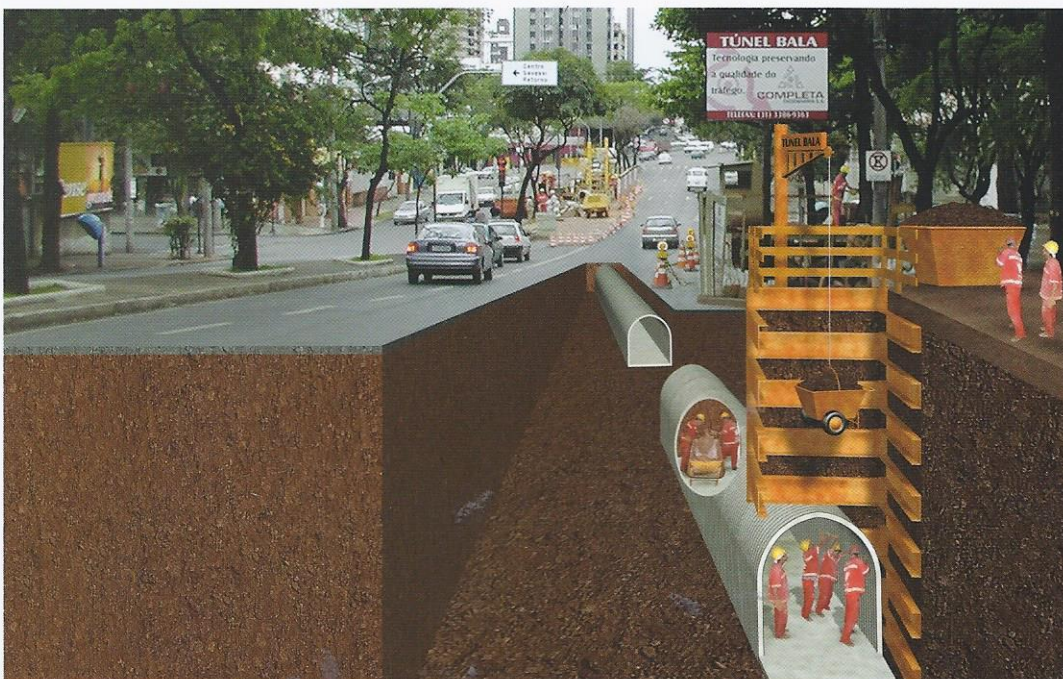
Canalização do Córrego das Mangabeiras pelo método não-destrutivo Túnel Bala. Cliente: Prefeitura Municipal de Belo Horizonte
